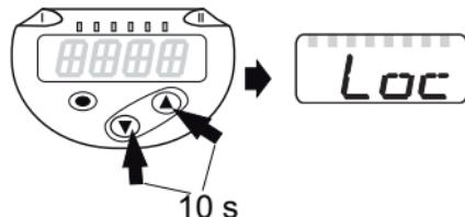
Во время эксплуатации: [Loc] отображается кратко при попытке внесения изменений в значения параметров.
