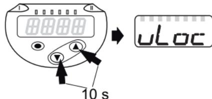
Заводская настройка прибора: в незаблокированном состоянии.
