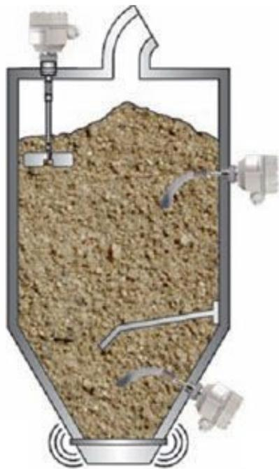
При расположении прибора на боковых стенках подведение кабелей должно происходить снизу.
