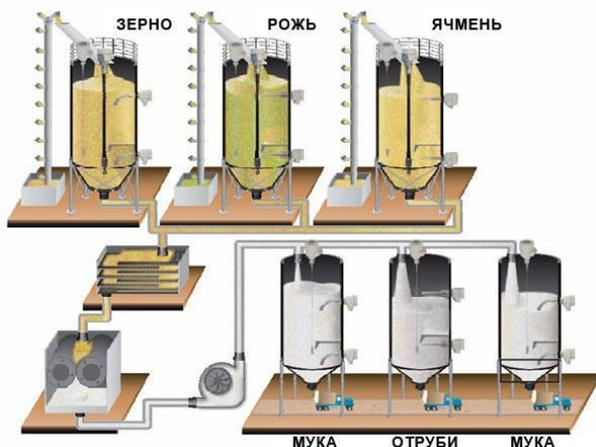
Наиболее оптимально датчики NIVOROTA подойдут для задач контроля уровня в технологических процессах с высокой запыленностью в пищевой/строительной промышленности.
