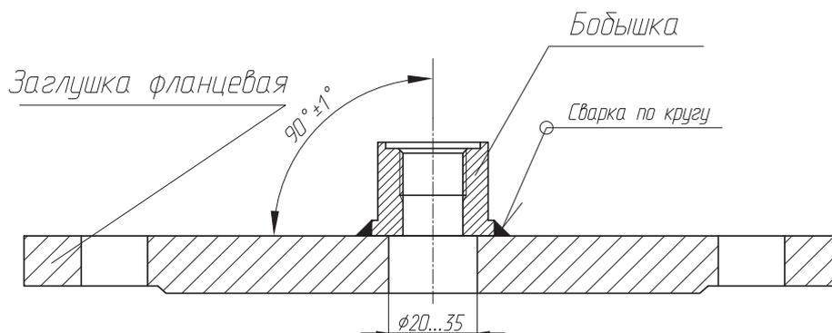
*Отверстие просверлить сверлом или прорезать сварочным аппаратом по центру заглушки*
