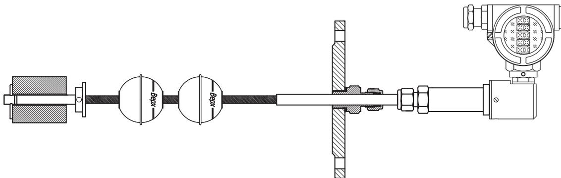
**А.7.** Расположите уплотнительную фланцевую прокладку (может входить в комплект поставки по запросу) по центру фланца монтажного патрубка.
