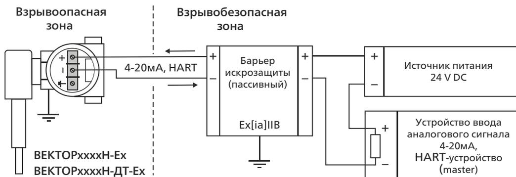
РИСУНОК 28. Схема подключения уровнемеров ВЕКТОРXXXXН-Вн, ВЕКТОРXXXXН-ДТ-Вн
