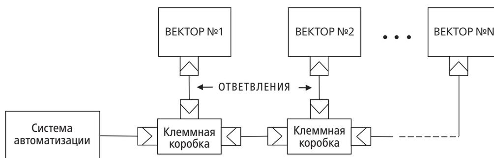
ПРИМЕЧАНИЕ 1. Число уровнемеров ВЕКТОР при объединении в шину не более 32.
