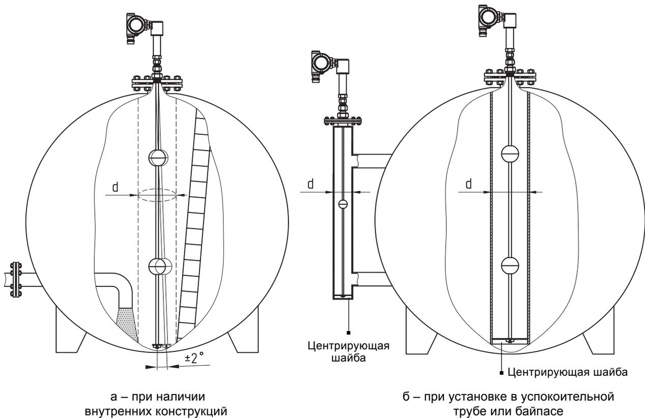
На рисунке 3а показано правильное расположение уровнемера в основном рабочем пространстве резервуара, с учетом возможных ситуаций, влияющих на правильное функционирование уровнемера.
