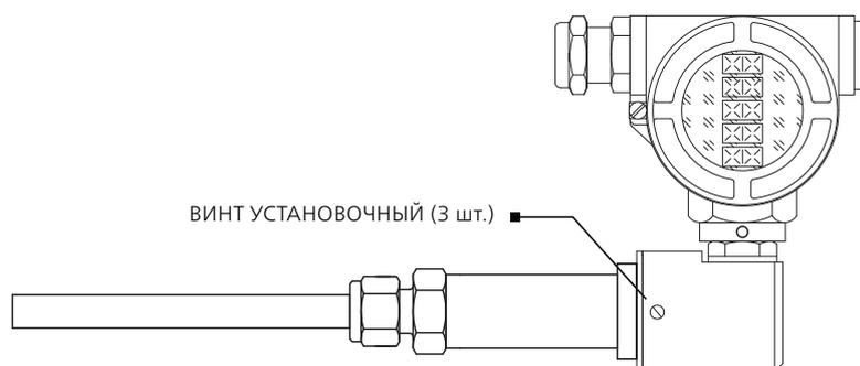
**4.2.2. Аккуратно снимите крышку с корпуса, не применяя при этом грубую физическую силу.**
