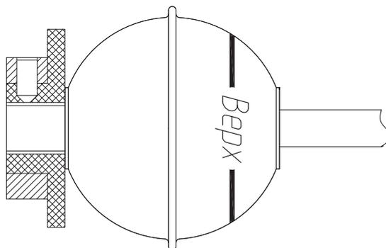
**А.8.** Закрепите фиксатор в установленном положении по п. А.6 или А.7 при помощи трех винтов (входят в комплект).
