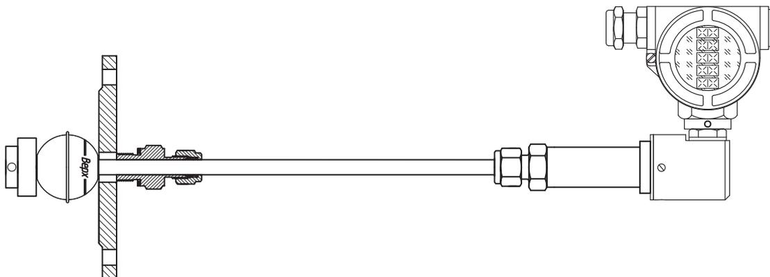
**А.10.** Расположите уплотнительную фланцевую прокладку (может входить в комплект поставки по запросу) по центру фланца монтажного патрубка.
