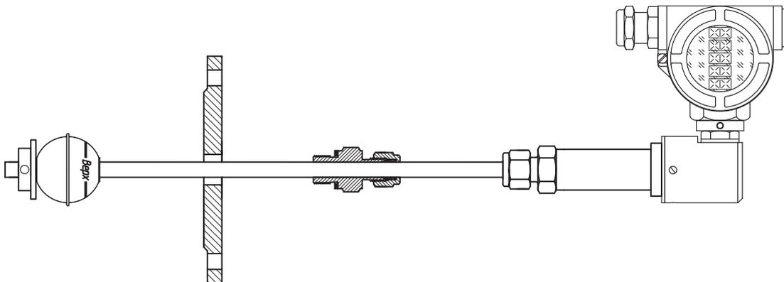
**ПРИМЕЧАНИЕ.** В случае если уровнемер имеет несколько поплавков, то первым на измерительный элемент должен устанавливаться поплавок с наименьшей плотностью, следующим – с большей, и так далее. Значение плотности выгравировано на поплавках.
