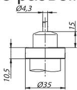
Кабельный ввод с трубкой компенсации атмосферного давления
