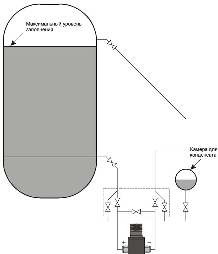
2.4.6. При прокладке питающих и сигнальных линий следует исключить возможность попадания конденсата на кабельный ввод датчика (см. рис 4.)
