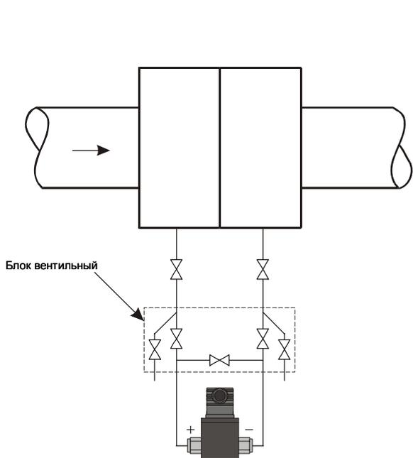
**Рисунок 3.** Монтаж датчика для измерения давления жидкости.
