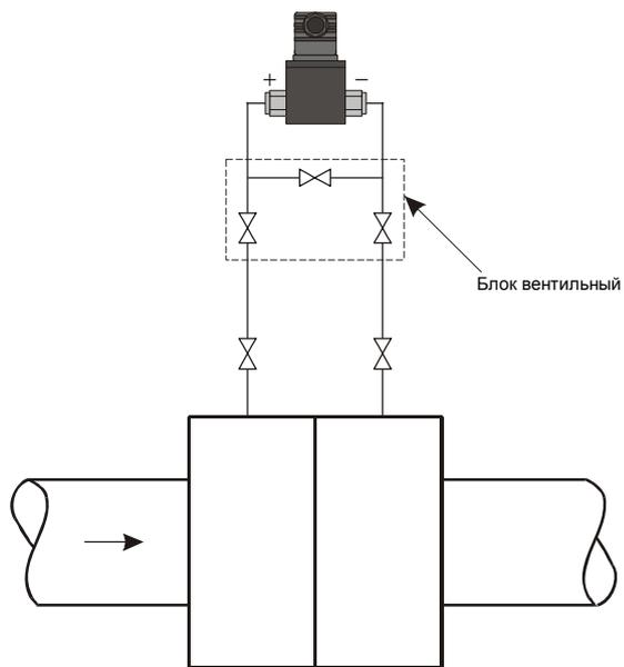
**Рисунок 1.** Монтаж датчика для измерения давления газа.
