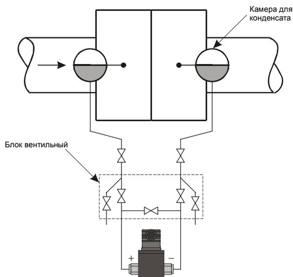
**Рисунок 2.** Монтаж датчика для измерения давления пара.
