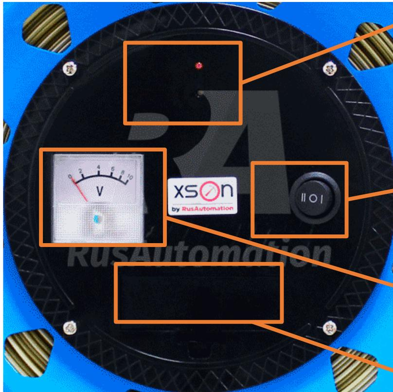
3) Звуковой сигнал и LED лампочка для сигнализации достижения зондом поверхности воды.
