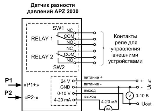
P1, P2 – входное давление измеряемой среды, при этом вход P1 (+) используется для более высокого давления, а P2 (-) для более низкого.
