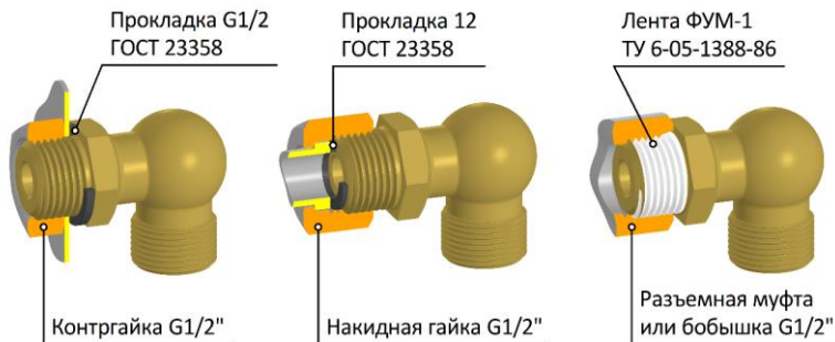
Рисунок 8.2 – Способы уплотнения присоединительной резьбы
