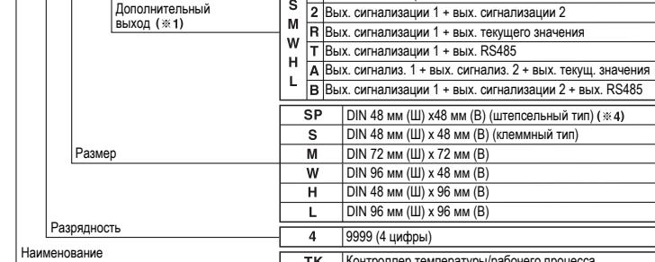
\* 1 В случае серии SP возможности выбора дополнительного выхода управления и функциональность цифрового входа будут ограничены числом выводов.
