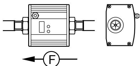
Направление потока горизонтальное, прибор вертикально, разъемом вверх.
