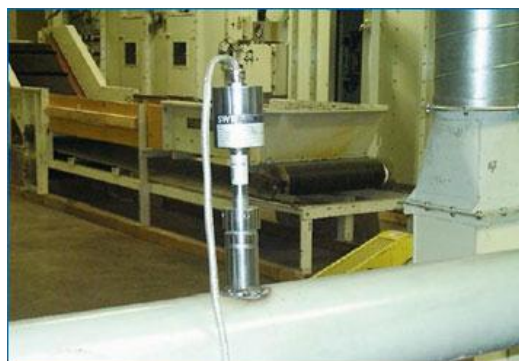
Измерение расхода сыпучих веществ в пневмотранспорте
