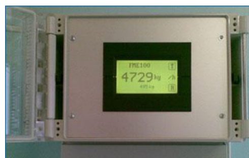
Показания модуля обработки (трансммитера) в процессе перекачки муки
