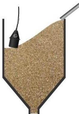
[Датчики уровня наклонного типа](#) применяются в качестве сигнализаторов верхнего предельного уровня сыпучих материалов (зерно, комбикорм, песок, гравий и т.п.), а так же в качестве [датчиков заштыбовки](#) промежуточных течек конвейера.
