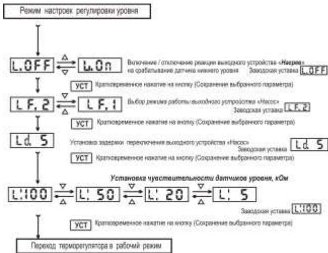
Рисунок 5 – Алгоритм программирования терморегулятора RATAF-02U (продолжение)
