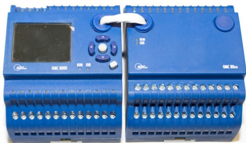
Рис. 3. Контроллер ОМС 8000 с подключенным модулем 8DI 10DOR
