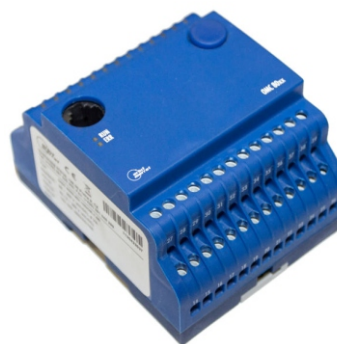
Рис. 4. Модуль 8DI 10DOR. Сверху видны два сквозных порта CAN-шины
