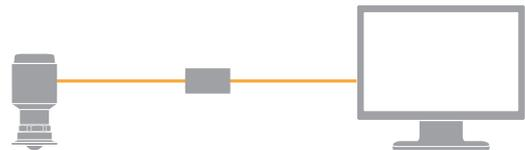
Das Gerät mit einem USB IO-Link Interface oder einem feldfähigen IO-Link-Master verbinden. Software Moneo oder LR DEVICE starten.
