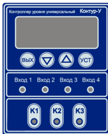
Лицевая панель контроллера «Контур-У-Н2»
