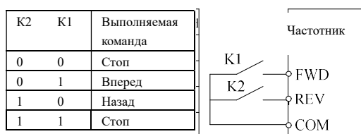
Рис.6-13 Двухпроводной режим управления 1
