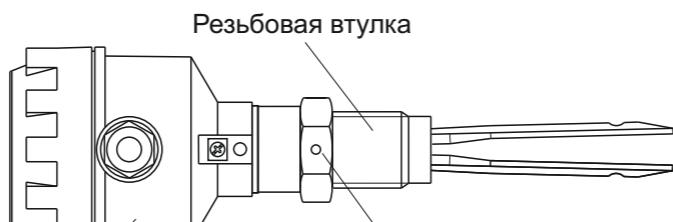
Указательная маркировка вибрационных стержней показывает их направленность после монтажа
