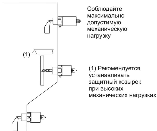
Стандартная муфтовая лопасть 40x98 мм позволяет производить установку датчика в штуцерный ввод длиной до 40 мм без ее демонтажа. При наличии штуцерного ввода большей длины, а также в условиях ограниченного пространства, необходимо применять датчик со складной лопастью 28x200 мм.
