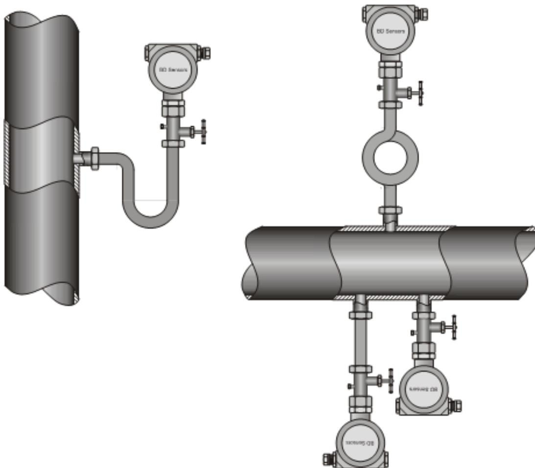
**Рисунок 3.** Варианты монтажа датчика для измерения давления пара.
