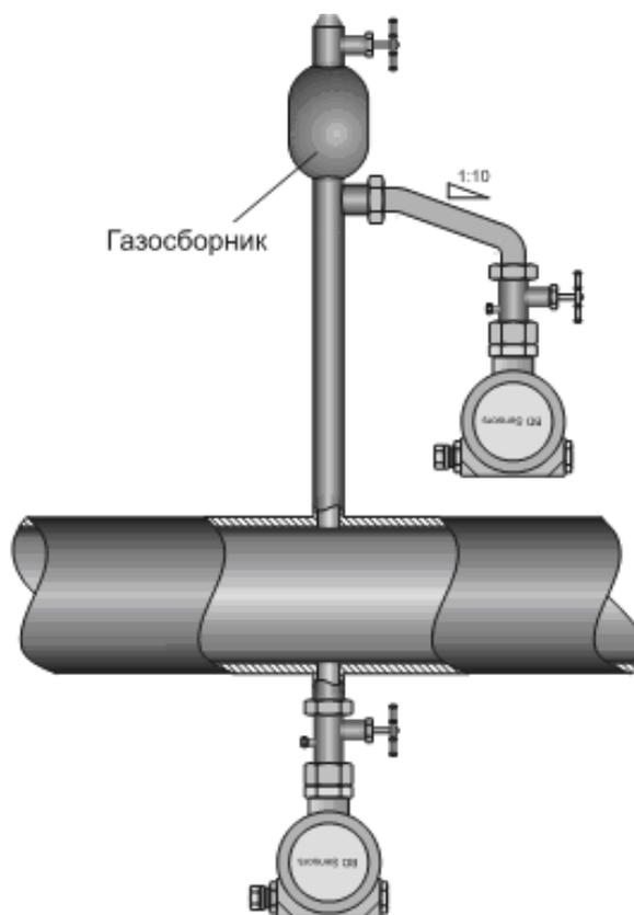
**Рисунок 2.** Монтаж датчика для измерения давления жидкости.
