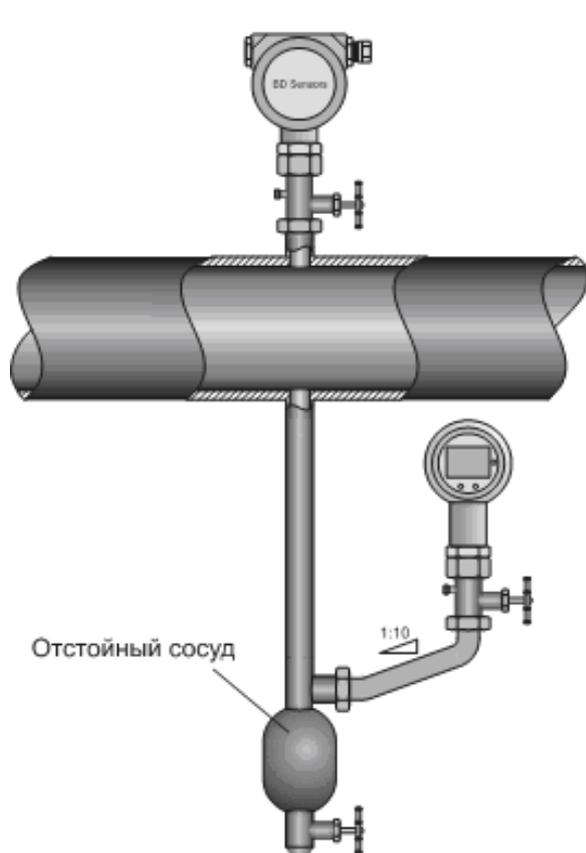
**Рисунок 1.** Монтаж датчика для измерения давления газа.
