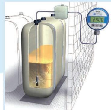
**Применение** Предназначен для постоянного измерения уровня в емкостях с жидким топливом EL, L или дизельным топливом, 100% биодизель (EN 14214). Специально предназначен для подземных емкостей или емкостей, установленных в подвалах. Для высоты наполнения от 0,9 до 4 м.
