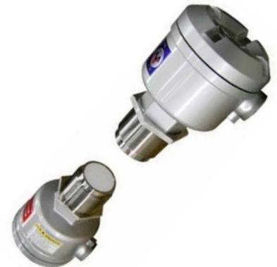
**Серии MWS-DP-3 и FS 510M.** Датчики определения наличия потока материала функционируют на основе эффекта Доплера и применяются для выявления факта прекращения потока материала без определения причины: имеет ли место затор или материал вообще отсутствует в контролируемом участке пространства.
