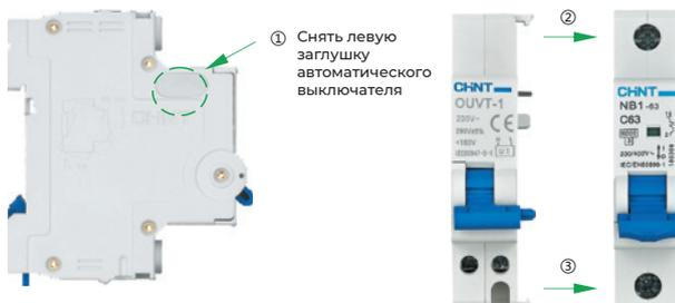
После сборки OUVT-X1 и автоматического выключателя установите их на стальную монтажную рейку TH35-7.5.
