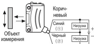
※ ① :Подключение нагрузки к NPN-выходу с открытым коллектором
