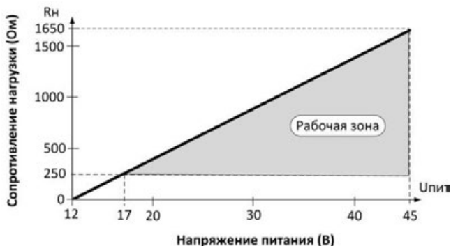
Рисунок В.9 – График ограничений по выбору сопротивления нагрузки (Rн), в зависимости от напряжения питания
