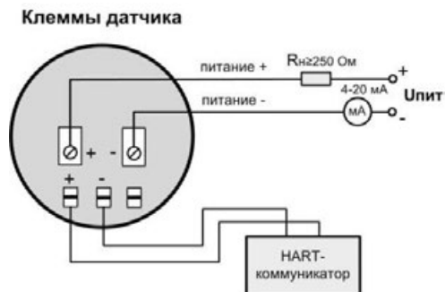
Рисунок В.8 – Подключение HART-коммуникатора с временно устанавливаемым на его входе дополнительным резистором нагрузки (R) сопротивлением 250 Ом
