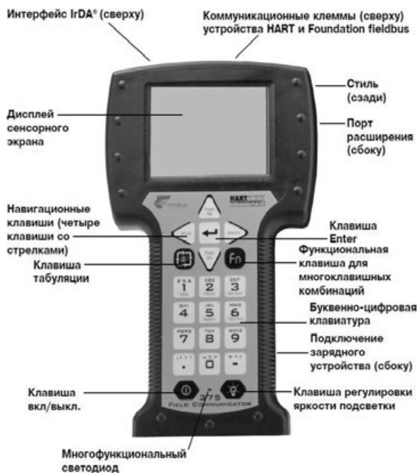
Рисунок Д.1 – Назначение элементов управления коммуникатора модели 375
