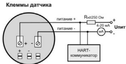
Рисунок В.6 – Способ подключения HART-коммуникатора непосредственно к коммуникационным клеммам прибора
