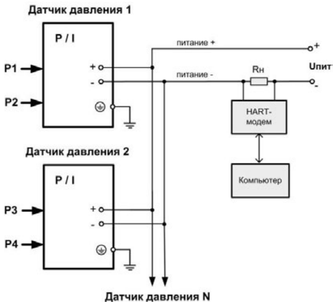
Рисунок В.4 – Подключение нескольких приборов AMZ 5050/AMZ 5450 к одной линии питания (P1–P4 – давление измеряемой среды, R_n \geq 250 \text{ Ом} )
