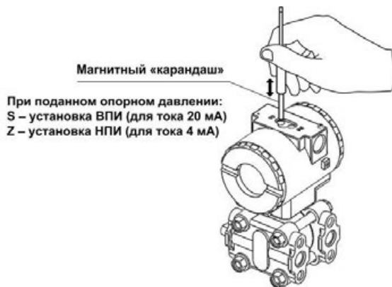
Рисунок 6.1 – Расположение местных регуляторов настройки, отверстие установки нуля обозначено Z (Zero), диапазона – S (Span)
