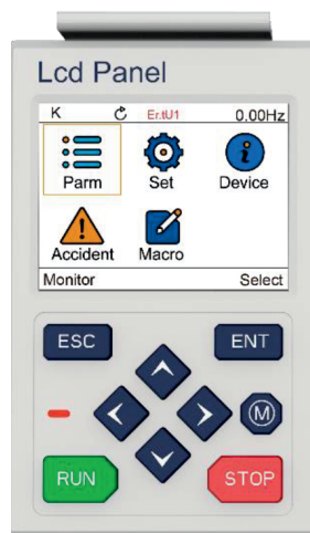
Рисунок 4.18 – Внешний вид LCD-пульта управления RCP-K750-LCD
