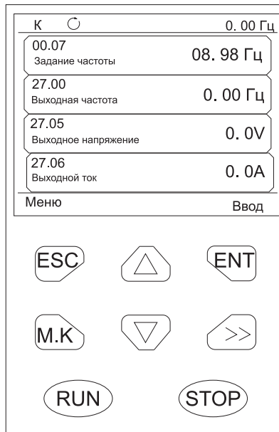
Рисунок 4.1 – Внешний вид LCD-пульта управления
