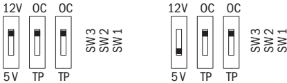
Рисунок 7.1 – Положение DIP-переключателей для энкодера типа разомкнутого коллектора, Push-pull на плате энкодера EC-K750-PG-INC1
