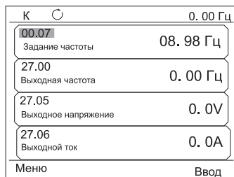
Рисунок 4.17 – Меню редактирования монитора состояния
