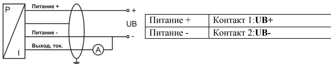
Рисунок В.3. Двухпроводная схема включения (токовый сигнал)
