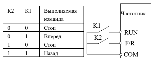
Рис. 6-14 Двухпроводной режим управления 2
