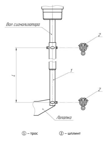
Рисунок 8.1 – Общий вид удлинителя
