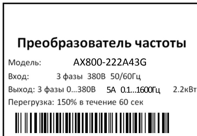
Рис. 1-1. Паспортная табличка преобразователя частоты INTEK
