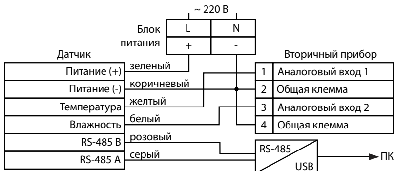
Рисунок 6 - Схема внешних электрических подключений датчиков HTE.PF-U10-RS
