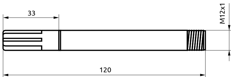
Рисунок 3 - Габаритные размеры HTE.PF с разъемом
