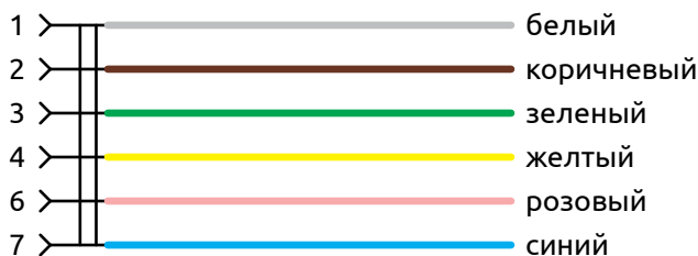
Рисунок 8 - Схема внутренних соединений разъема с кабелем HTE.Cable-M12-6F-xx
