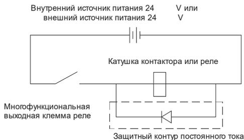
Рисунок 16 – Схема подключения выходного реле на постоянный ток
