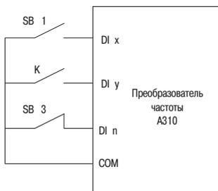
Рисунок 50 – Трёхпроводной способ управления 2
