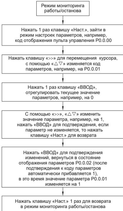
Рисунок 22 – Настройка параметров с помощью пульта управления
