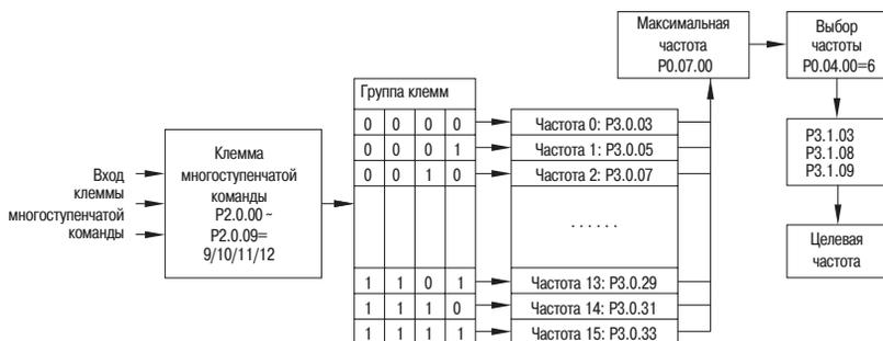
Рисунок 57 – Выбор многоступенчатой скорости
