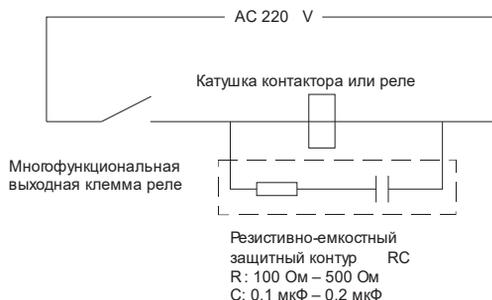
Рисунок 15 – Подключение выходного реле на переменный ток
