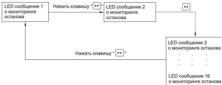
Рисунок 20 – Алгоритм просмотра состояния преобразователя частоты
