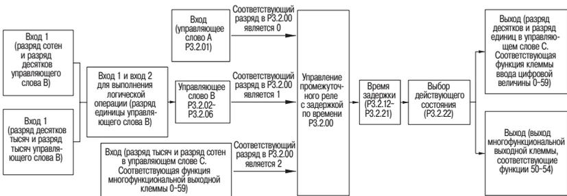
Рисунок 63 – Программирование промежуточного реле
