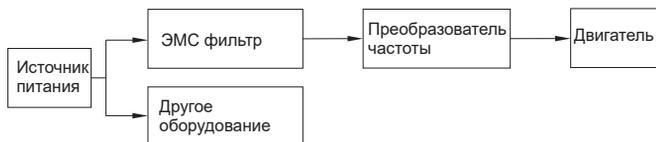
Рисунок 10 – Подключение фильтра со стороны входа
