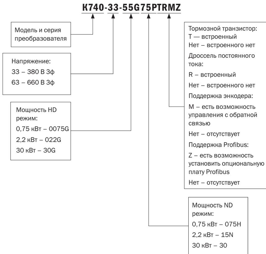
Рисунок 1 – Пример расшифровки артикула преобразователя частоты
