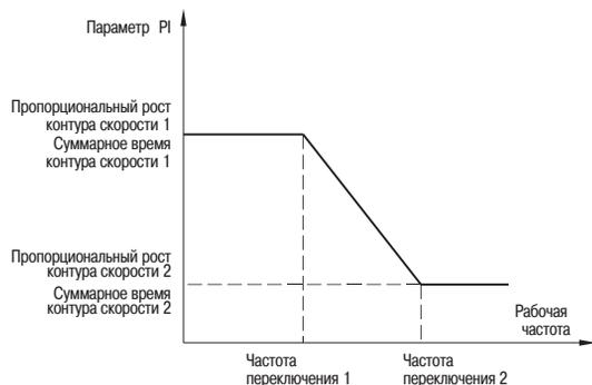
Рисунок 29 – Частоты переключения
