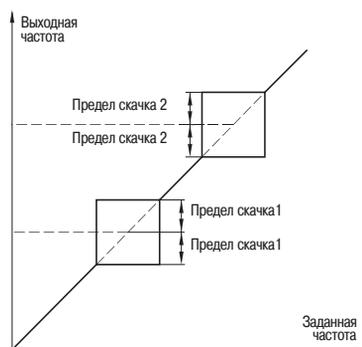
Рисунок 27 – Скачкообразные частоты
