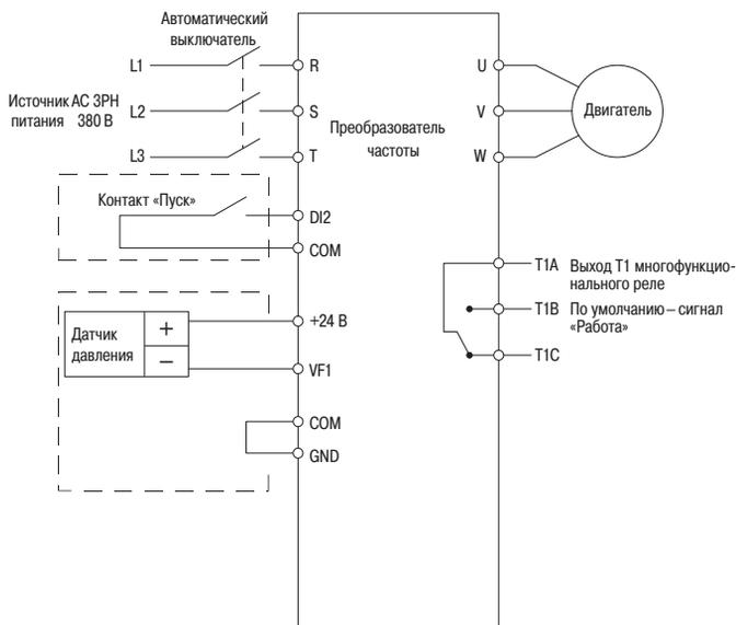
Рисунок 80 – Схема подключения преобразователя частоты для поддержания давления с датчиком с сигналом 4-20 мА
