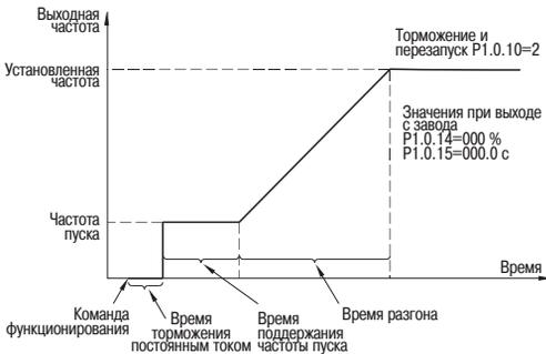
Рисунок 53 – Пуск с торможением постоянным током
