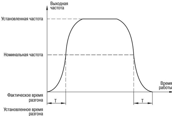
Рисунок 25 – S кривая ускорения и замедления
