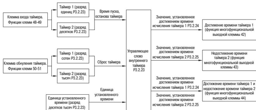
Рисунок 69 – Настройка внутренних таймеров
