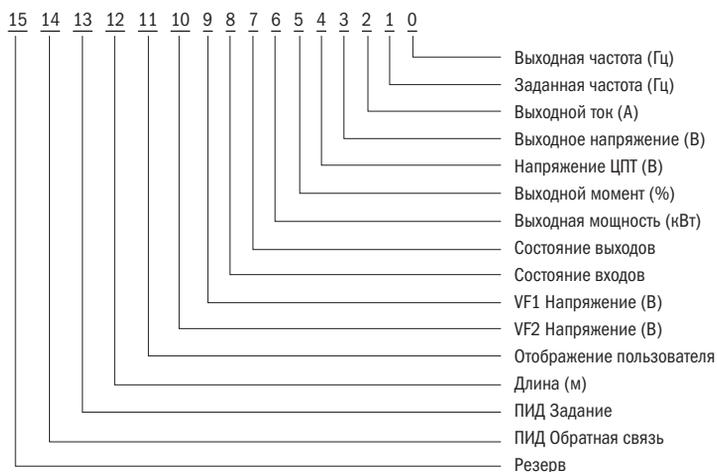
Рисунок 41 – Отображение 1 LED при работе
