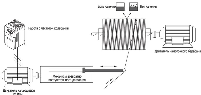
Рисунок 73 – Пример оборудования для использования частоты колебания
