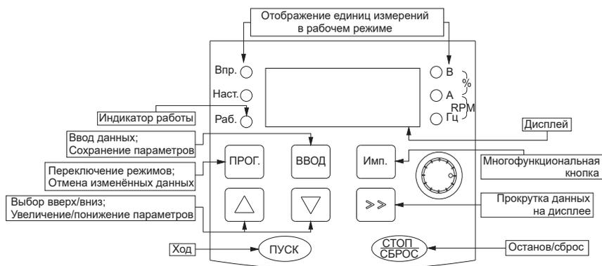
Рисунок 18 – Пульт управления преобразователем частоты
