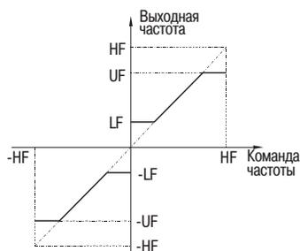
HF – максимальная частота, UP – верхний предел частоты, LF – нижний предел частоты
