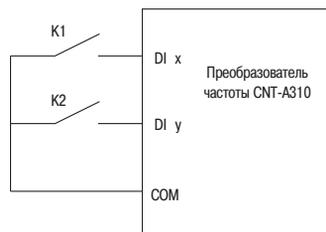
Рисунок 47 – Двухпроводной способ управления 1
