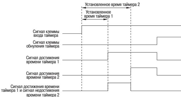
Рисунок 70 – Обнуление таймеров
