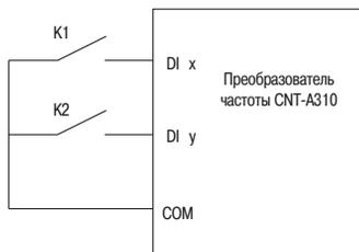
Рисунок 48 – Двухпроводной способ управления 2
