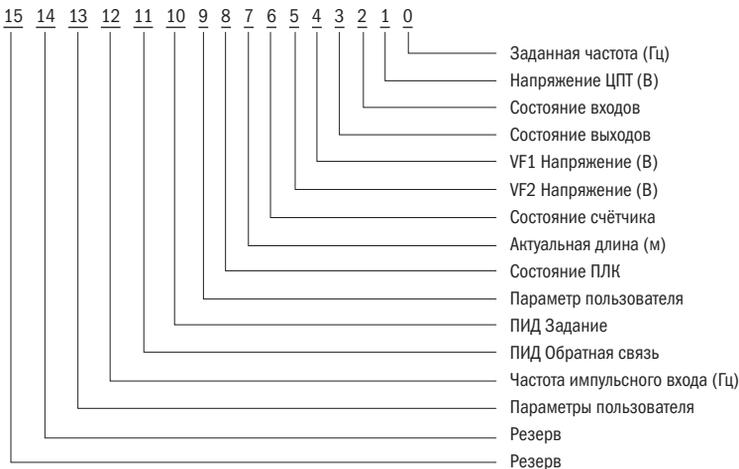
Рисунок 43 – Отображение LED при остановке
