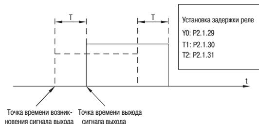
Рисунок 78 – Задержка срабатывания выходного реле
