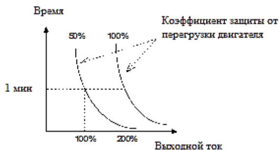
Рис. 6-27 Кривая защиты двигателя от перегрузки
