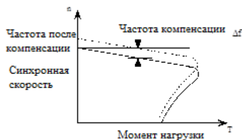
Рис. 6-11 Автоматическая компенсация скольжения
