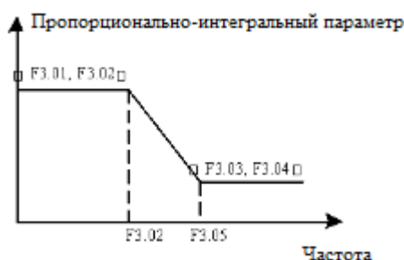
Рис. 6-7 Схема пропорционально-интегральных параметров контура скорости
