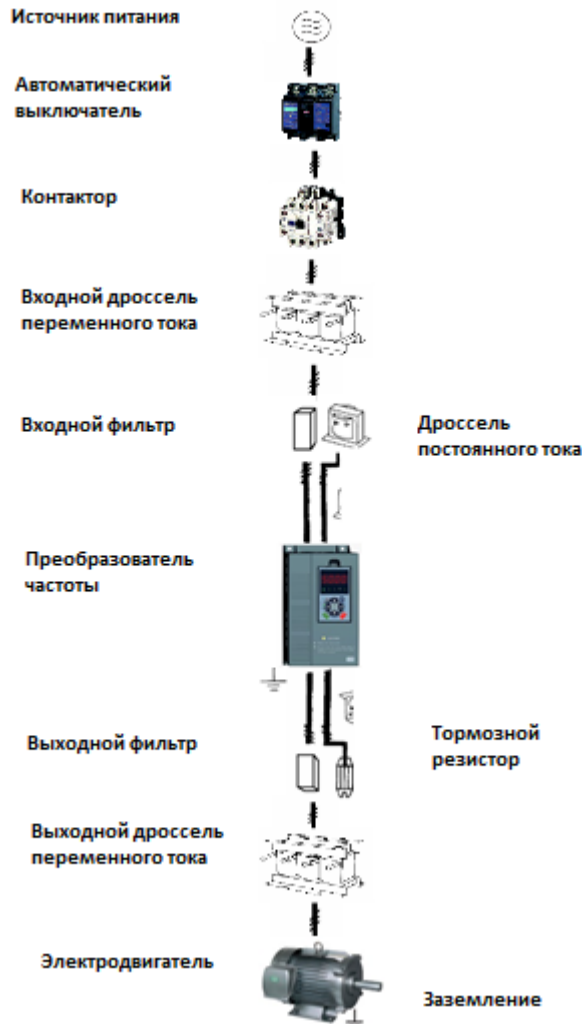
Рис 3-1 Подключение периферийных устройств к преобразователю
