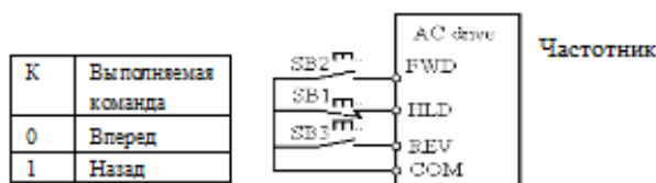
Рис.6-16 Трехпроводной режим управления 2
