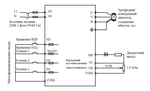
Категорически запрещается подсоединять питающее напряжение к выходным клеммам U V W.
