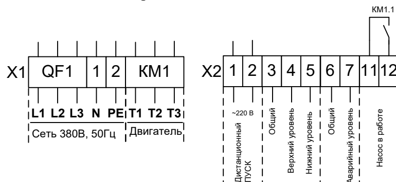
Рис.4 Схема подключения СУ-ЗН.
