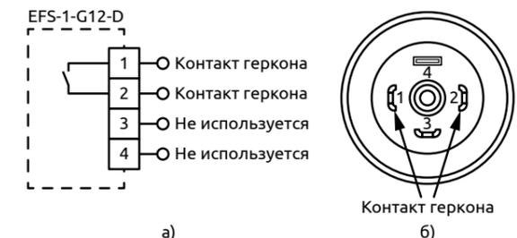
Рисунок 5 – Подключение электрических цепей реле: а) схема подключения; б) расположение контактов в разъеме.
