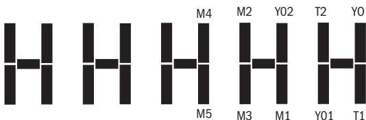
Рисунок 47 – Монитор состояния промежуточных реле
