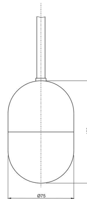
В комплект датчика входит груз для крепления на кабеле. Груз на кабеле необходимо размещать с учетом особенностей места установки датчика.
