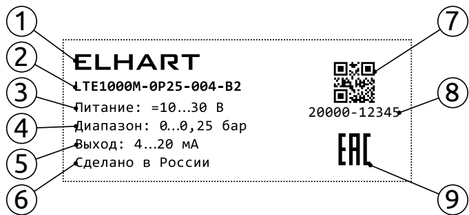
Рисунок 2 - Пример гравировки корпуса датчика
