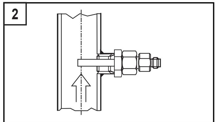
Трубные изгибы, клапаны, редукторы и другие компоненты приводят к турбулентности среды. Это влияет на точность измерения прибора.
