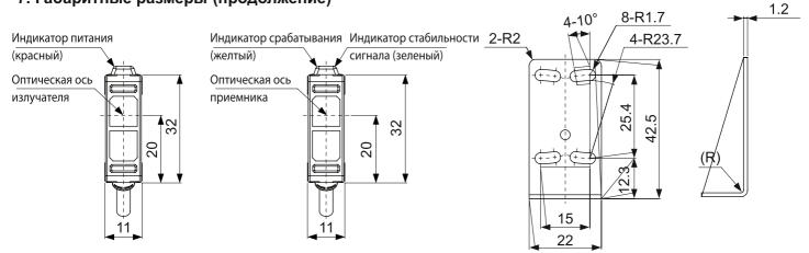
[датчики, срабатывающие на просвет (излучатель)] [датчики, срабатывающие на просвет (приемник)]
