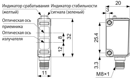
[датчики с обратным отражением /датчики с диффузионным отражением]
