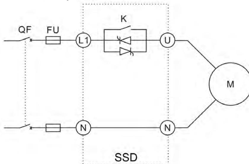
QF — автоматический выключатель, FU — предохранитель (прил. 1),
