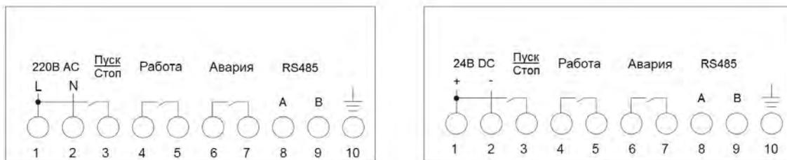
Момент затяжки винтов на клеммах - 0.2 Нм.
