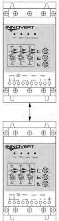
3) При установке двух или более устройств плавного пуска горизонтально друг от друга, расстояние между ними должно составлять не менее 50 мм.
