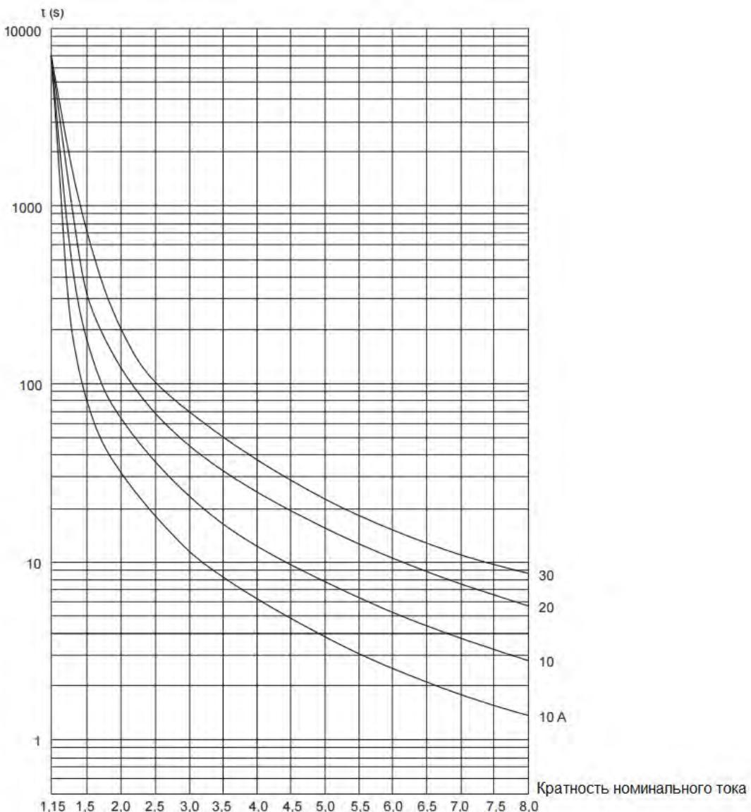
Таблица 9 — Время срабатывания защиты от тепловой перегрузки
