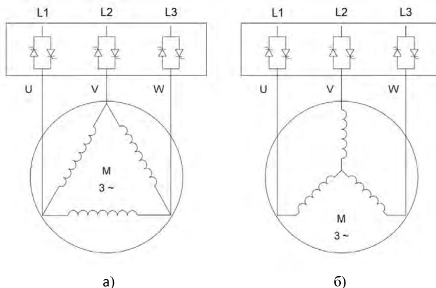
Схемы подключения обмоток электродвигателя: а) по схеме «треугольник»
