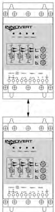
3) При установке двух или более устройств плавного пуска горизонтально друг от друга, расстояние между ними должно составлять не менее 50 мм.
