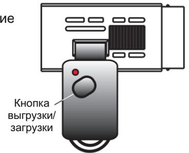
Устройство KEY имеют встроенный элемент питания. Для длительного срока службы необходимо отсоединить устройство от термоконтроллера после процесса передачи.
