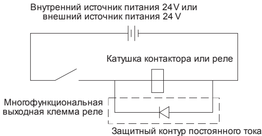
Рисунок 18 – Схема подключения выходного реле на постоянный ток
