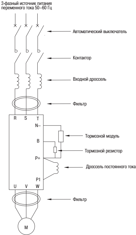
Рисунок 8 – Подключение периферийных устройств
