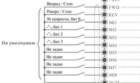
Общая клемма дискретных сигналов при использовании внутреннего ист. питания для работы входов в режиме NPN (Sink Mode)
