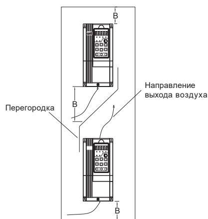
Рисунок 3.3 – Ориентация при последовательной установке нескольких ПЧ сверху и снизу и требования к свободному пространству
