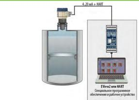
Если устройство настроено на передачу тока (4...20 мА, короткий адрес HART® «0»), в контуре связи HART® можно использовать только одно устройство..
