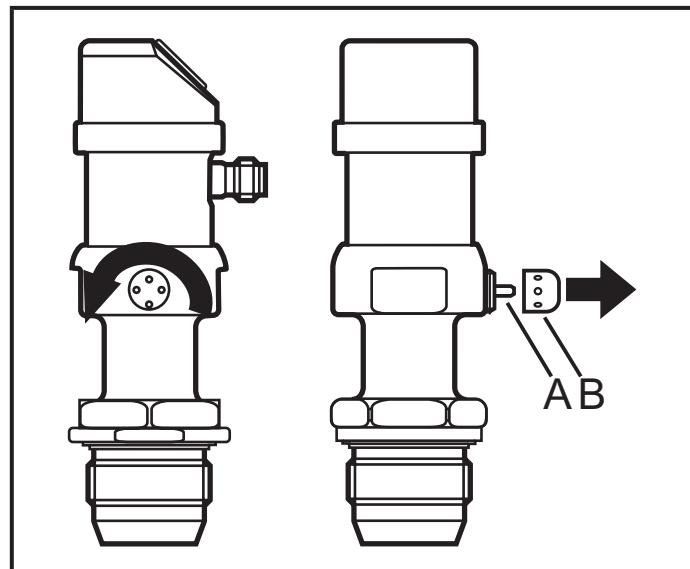
К работам по очистке воздушного клапана (A) допускается только квалифицированный персонал. Во время работы требуется особая осторожность.
