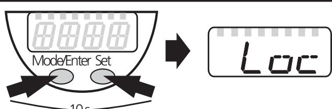
Во время эксплуатации: [Loc] кратко отображается на экране, если Вы пытаетесь изменить значения параметров.
