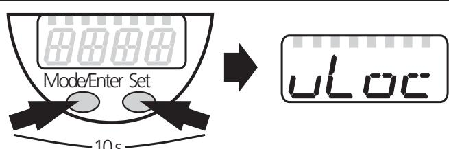
Заводская настройка прибора: В разблокированном состоянии.
