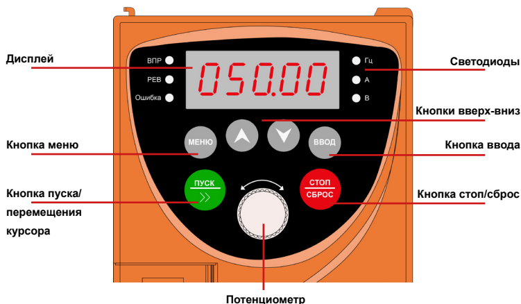
Рисунок 5.1 – Функции кнопок и светодиодов панели управления INVENT
