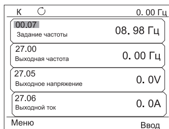
Рисунок 4.17 – Меню редактирования монитора состояния
